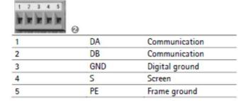
カードのコネクタ部分に端子台つきコネクタ(インターフェースカード付属品)が接続されます。上記ピンアサインにて信号ケーブルを接続してください。
