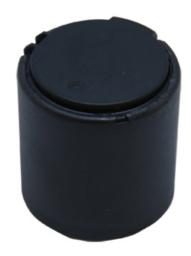
LVC -Linear Vibration Components-シリーズは独自のバネ構造・減衰構造により高次共振を抑制してワイドバンドでクリアな振動を実現します。 また、ボイスコイル(VCM)の原理を応用しており、パネルなどの面を直接振動させることによって音を出すことができるため、筐体の裏に取り付けることで意匠に与える影響を抑えながらスピーカー機能を追加することができます。
