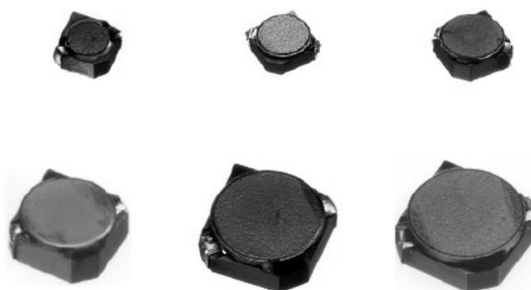
電池駆動の携帯型電子機器の電源（DC-DCコンバータ・スイッチング電源）、その他電子機器用の高効率（低DCR）チョークコイルです。
