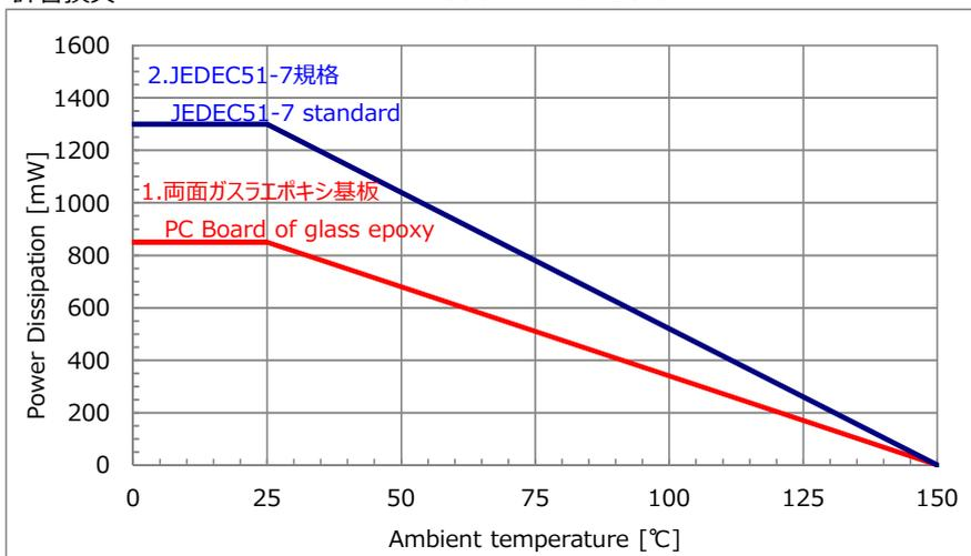
ICの放熱性を上げる為にはパッケージ裏面にGNDもしくは放熱PADパターンを配置し、
