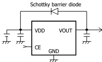
10. 超小型等の容量変化が激しいコンデンサを使用する場合、動作不安定となる恐れがあります。
