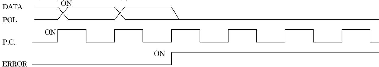
※ ERROR 出力時は、ERROR 信号の出力トランジスタが ON(電氣的な論理では負論理)となります。
