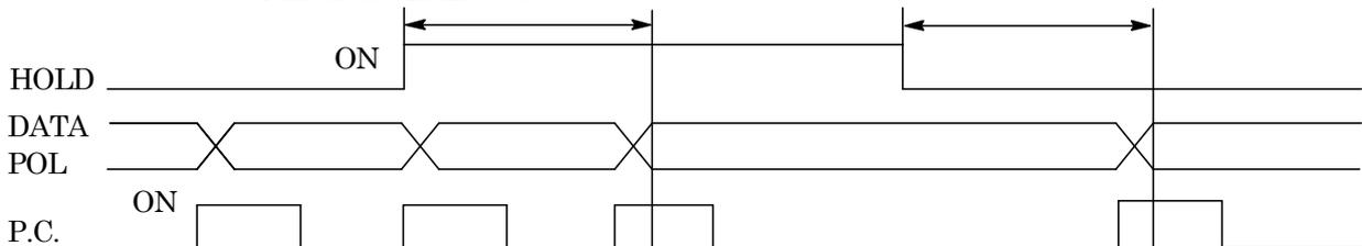
※ HOLD 信号入力時は、P.C.の出力トランジスタが OFF(電氣的な論理では正論理)状態となります。
