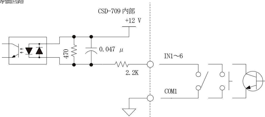
内部電源電圧 DC12V、短絡時電流 約5mA
