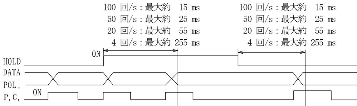
※HOLD 信号入力時は、P.C. の出力トランジスタが OFF（電氣的な論理では正論理）状態となります。
