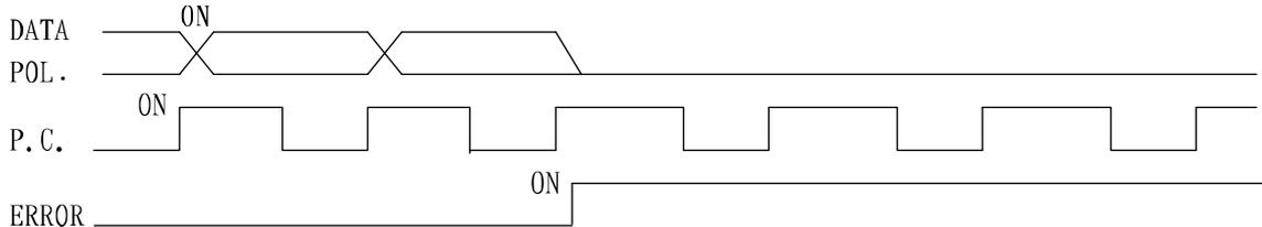
※ERROR 出力時は、ERROR 信号の出力トランジスタが ON（電氣的な論理では負論理）となります。
