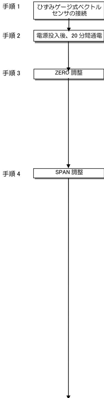
手順 1 本器とひずみゲージ式ベクトルセンサを接続します。
