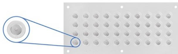
1. カバーテープ粘着面にメタルドームを搭載し、メタルドームにて基板（リジッドまたはフレキシブル）上のパターンをショートさせる構造としたもので、フィーリングに優れ、電気的にも安定。
